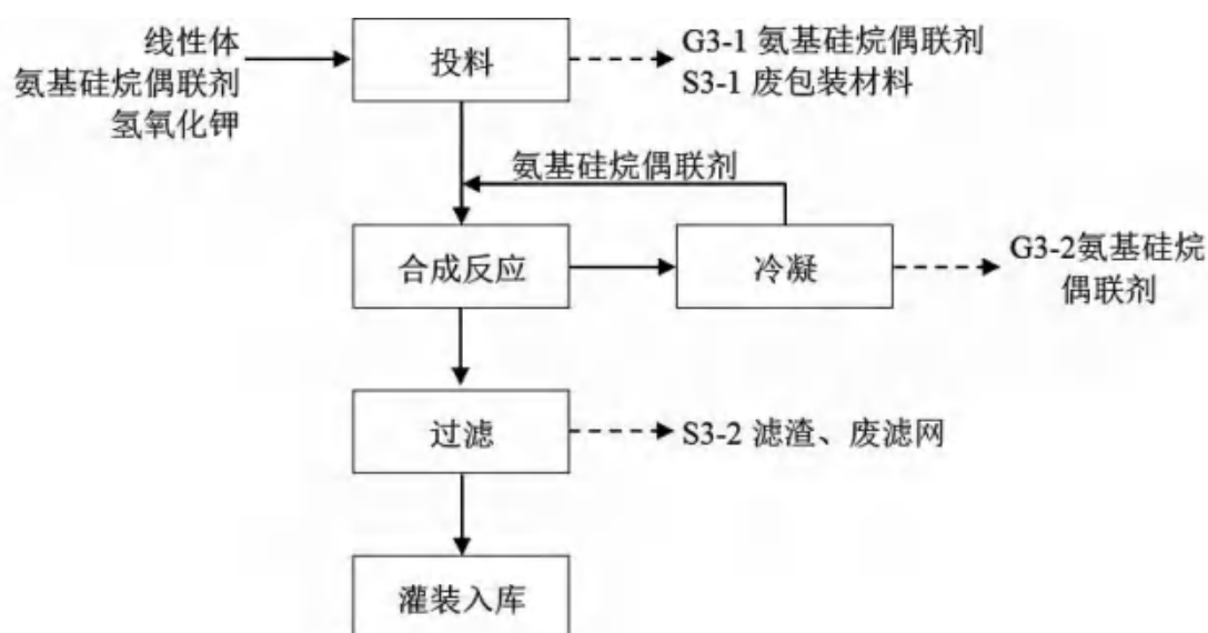
图 3.4-9 硅油乳液生产工艺流程图
