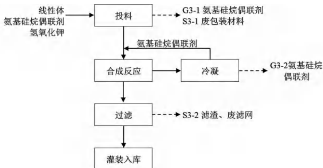
图 3.4-8 氨基改性硅油生产工艺流程图
